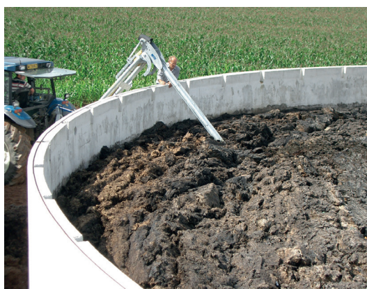
Utilisation du SPS dans un réservoir ouvert, hauteur +/- 3 m
