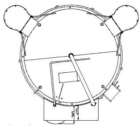
9 orifices de connexion, Ø 25 mm, répartis de façon égale sur le contour de la cu
