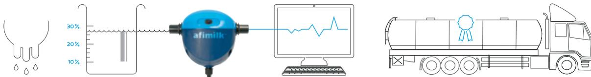
**Afilab** est placé entre le compteur à lait et le lactoduc à chaque poste de traite. Il mesure ainsi la composition du lait donné par chaque vache.
